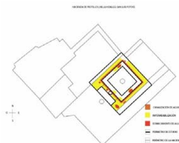
Figura 13 – Resultado de la inspección visual de las cubiertas de la estructura en donde se aprecia la falta de impermeabilización en las zonas colindante con los murales. En las áreas perimetrales del patio se ubica la canalización de las aguas pluviales. En la zona sur, sur oeste y sureste presenta problemáticas de estancamiento de agua. Elaborado por: T.M., 2017.
