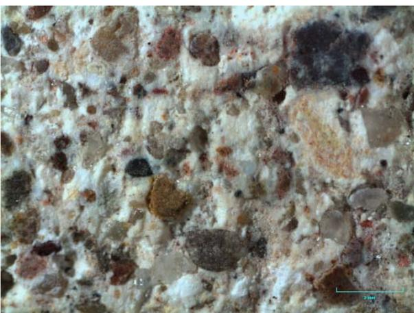
Fig. 11. Muestra 4, detalle de la textura granular del mortero (MO 2X).
