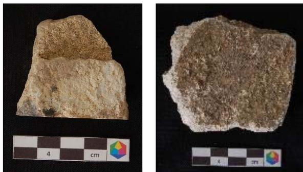
Fig. 5. Morfología a nivel macroscópico de las muestras de roca (muestra 2) y aplanado (muestra 4).
