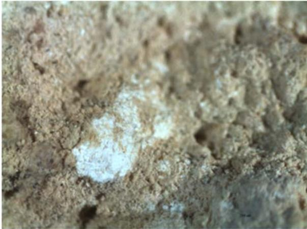
Fig. 10. Muestra 3, detalle del caliche en la composición del mortero (MO 2X).
