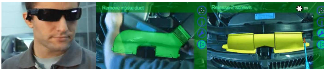
Fig. 22 (a): gafas, cascos, micro y sistema de comunicación integrado en técnico
