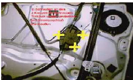
Fig. 21: Ejemplo de una serie de indicaciones para situar un motor
