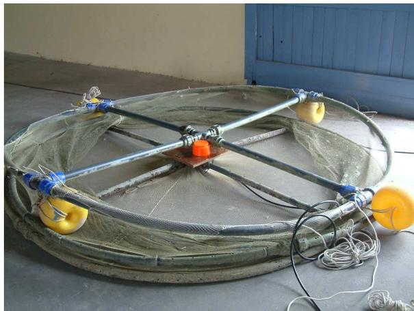
Figura 6. Detalle de montaje del transductor en el fondo de la jaula.
