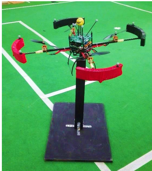
Figura 22 – Quadrotor anclado a la rótula del banco de pruebas.
