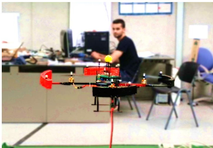
Figura 46 – Dron en vuelo hover estabilizado sobre el origen de coordenadas
