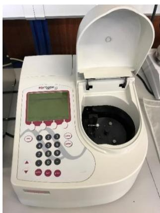
**Figura 7.** Espectrofotómetro (Biomate 3, Thermo scientific) utilizado en los estudios de crecimiento realizados para *H. pylori* en el Departamento de Biotecnología, Cátedra de Microbiología de la Universidad Politécnica de Valencia.
