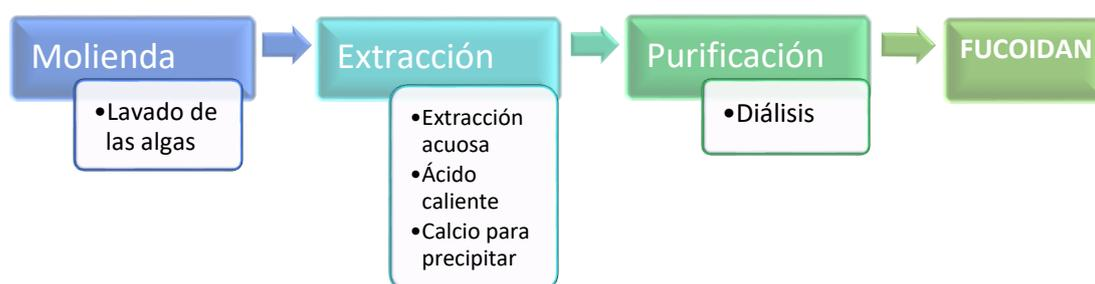
**Figura 5.** Proceso de extracción del fucoïdan procedente de algas pardas (Fuente: Tiago *et al.*, 2012)
