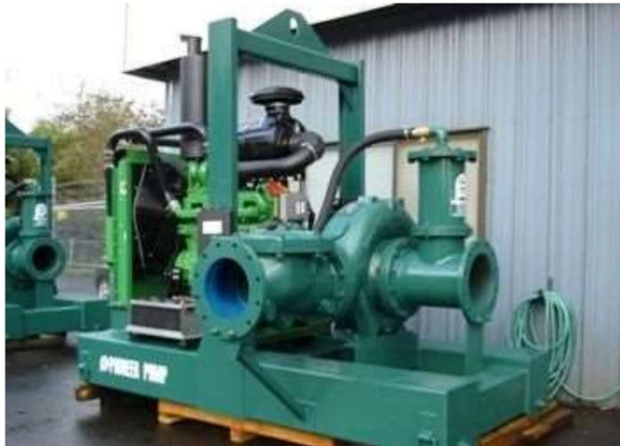
Figura 6. Bomba centrífuga de alto caudal
