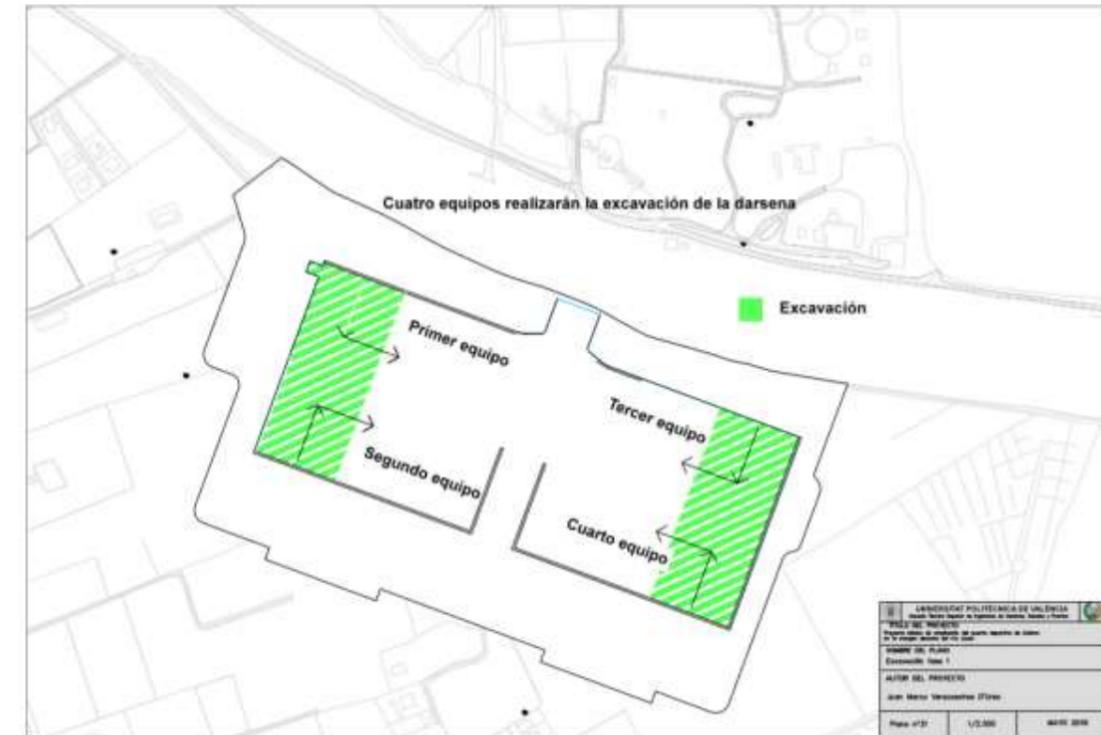
Figura 3. Primera fase de excavación
