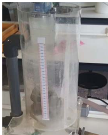
Figura 3.24. Rebosadero de agua.
