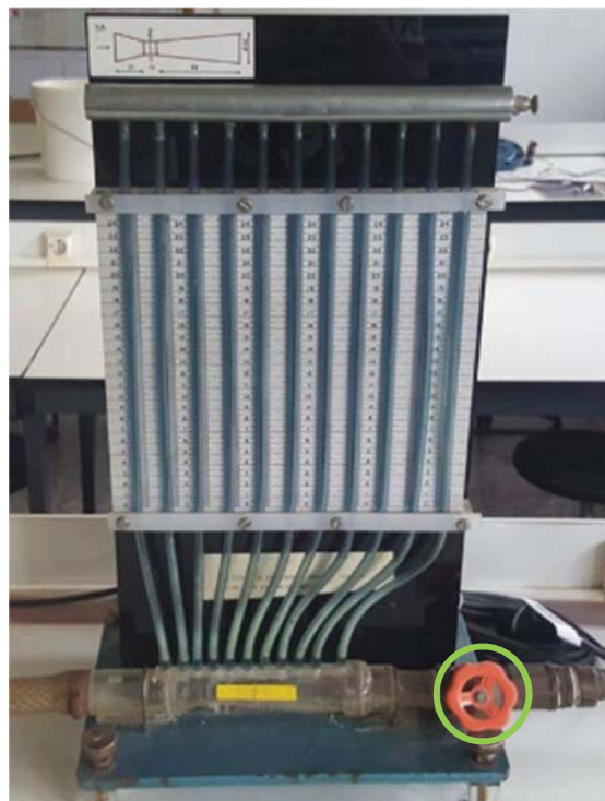
Figura 3.26. Tubo Venturi experimental. (Dispositivo apagado)
