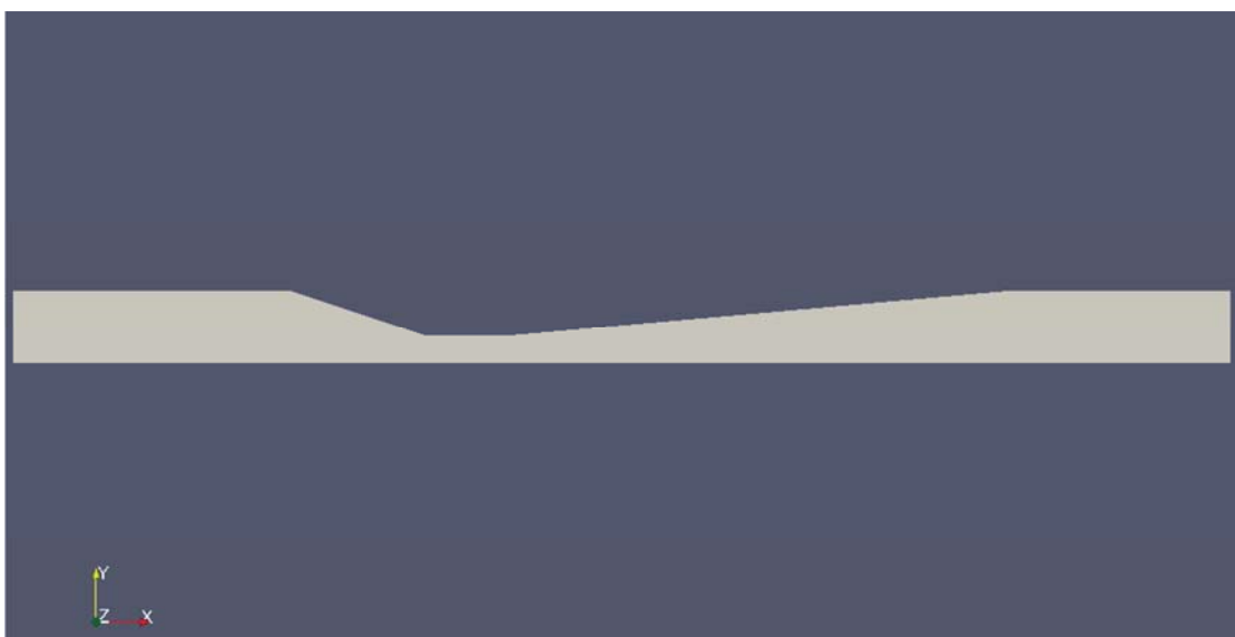
Figura 4.5. Diseño del nuevo tubo Venturi
