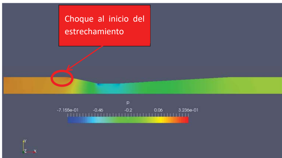
Figura 4.3. Representación gráfica del campo de presiones a lo largo del tubo Venturi.
