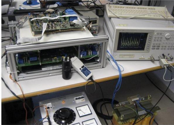
Figura 7.17, Montaje experimental, medición de la corriente en el condensador de DC-link.
