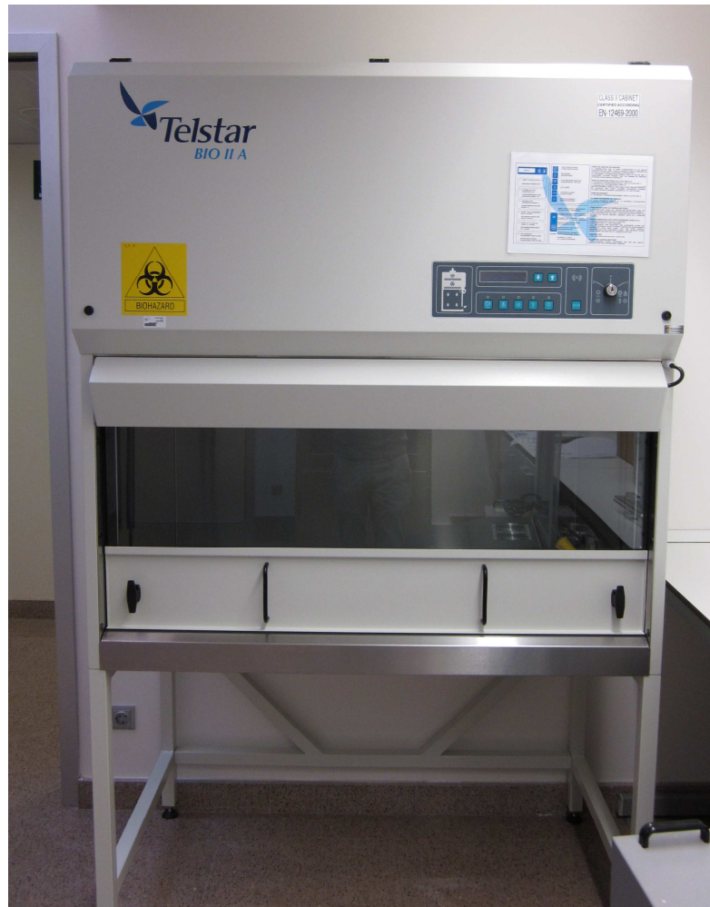
Figura 42. Cabina seguridad biológica clase 2A
