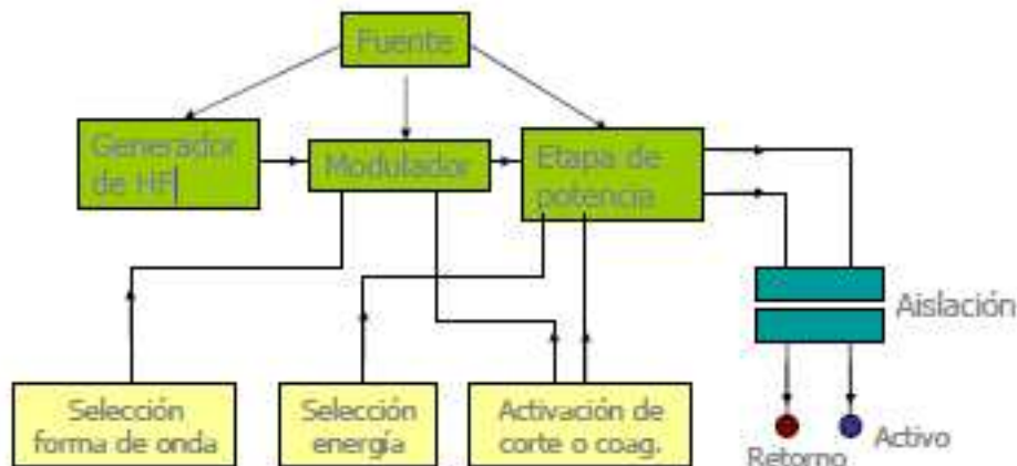
Figura 36. Diagrama bloques electrobisturí
