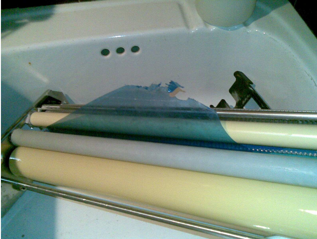
Figura 193. Placa atascada en rodillos
