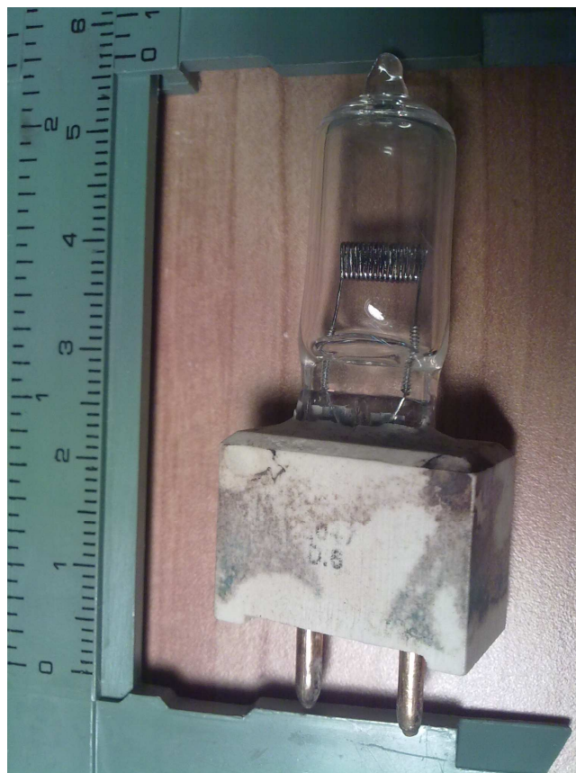
Figura 185. Bombilla en mal estado
