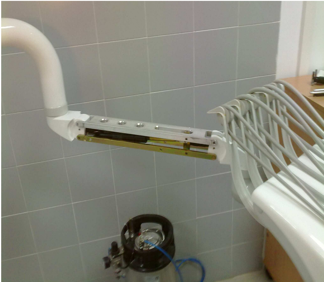
Figura 196. Amortiguador de sillón dental al descubierto
