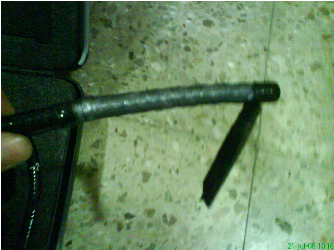
Figura 177. Recubrimiento extremo endoscopio rasgado
