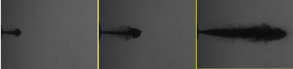
Figura 5.31: Visualización del chorro en condiciones transitorias con una ventana de 5.5 mm para p_i = 50 MPa y p_b = 1.5 MPa.
