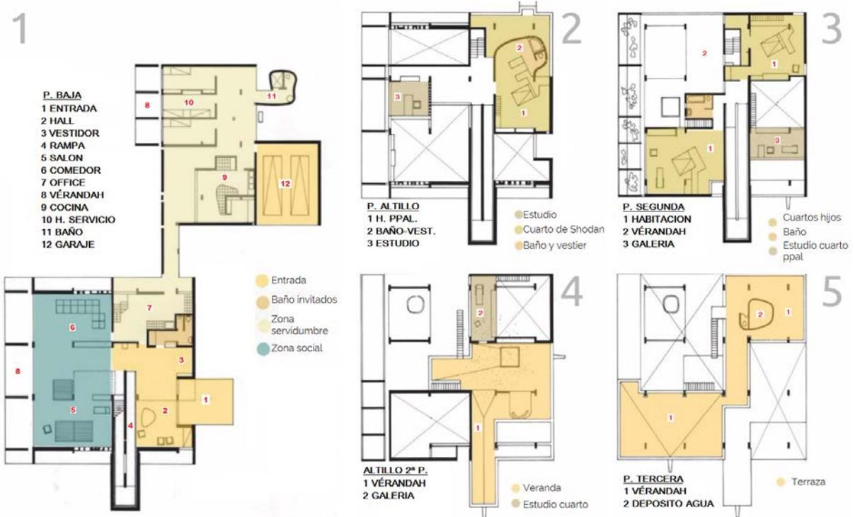
Fig. 33. "Esquema de Usos por planta".
