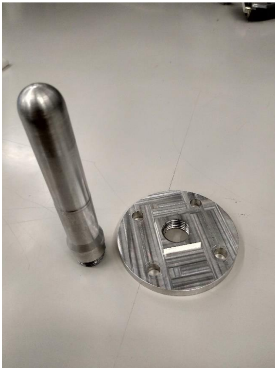
Figura 16- Herramienta de contacto mecanizada
