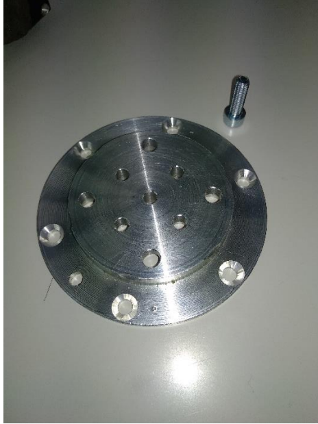
Figura 15- Adaptador del sensor al UR3 mecanizado
