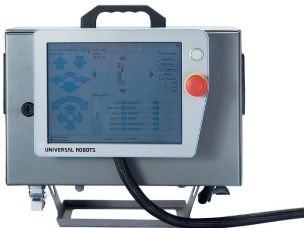
Figura 6- Caja de control con la consola colgada
