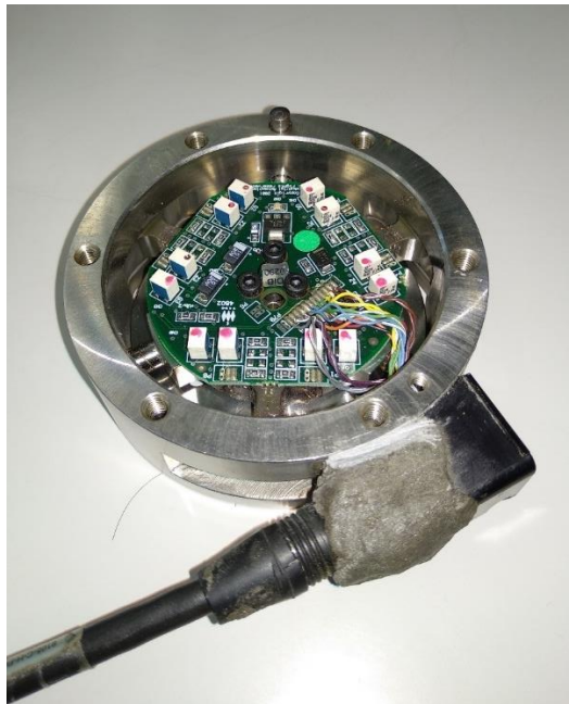
Figura 10- Sensor ATI Delta usado en el proyecto
