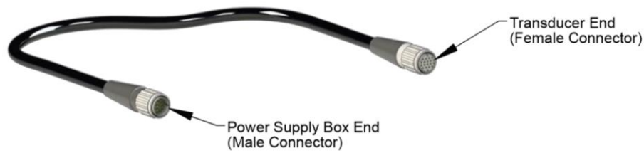
Figura 11- Dibujo del cable del transductor
