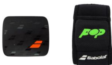
Figura 1.27: Muñequera instrumentada para el análisis del golpeo en tenis.
