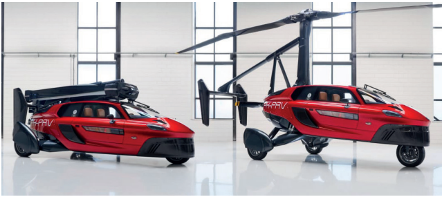
Fig.7 Pal V con helice plegada y desplegada
