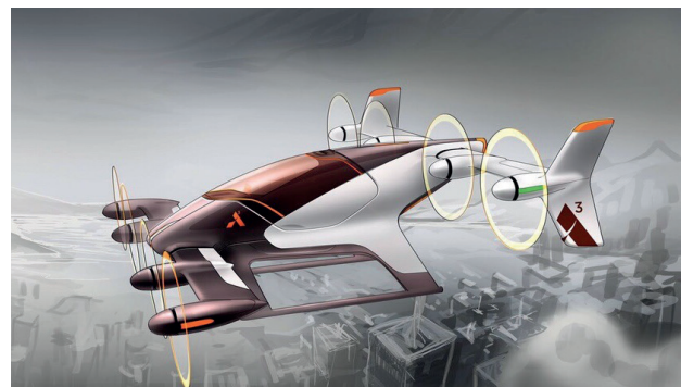
Fig.6 Vahana volando con las hélices en vertical
