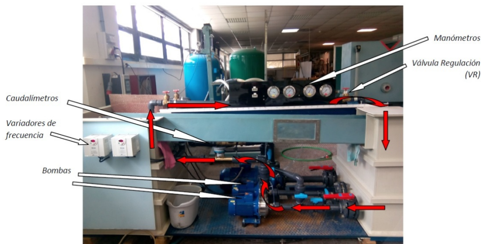
Figura 1. Ejemplo de fotografía incluida en el documento Parte II, en la descripción del banco de trabajo (Ensayo nº 3: Asociación en serie-paralelo).
