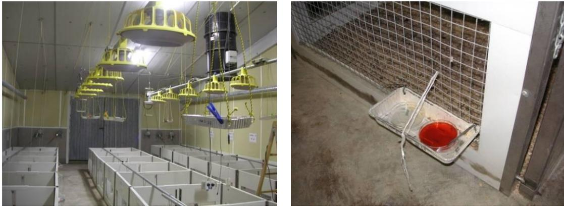
**Figura 5.** Placas expuestas en diferentes alturas de las salas y detalle de los medios de cultivos empleado y su colocación en bandejas.
