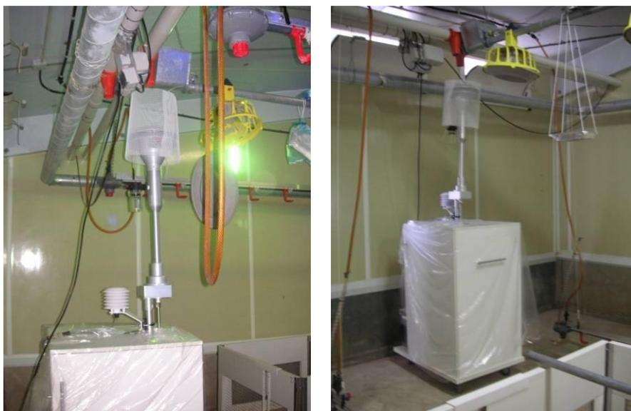
**Figura 9.** Equipo de muestreo en continuo de material particulado (TEOM)
