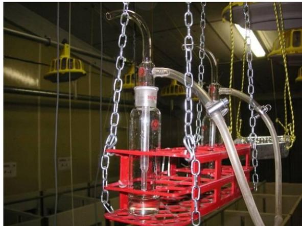
**Figura 6.** Detalle de borboteadores de aire suspendidos a una altura de 1,5 metros en el punto de muestreo en una de las salas.
