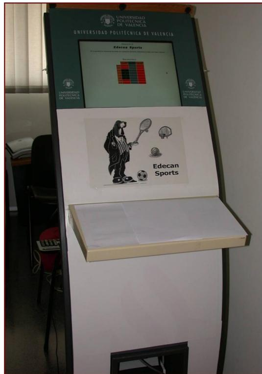
Figura 7.3: Fotografía del quiosco utilizado durante las pruebas. El quiosco incorpora una pantalla táctil, micrófonos y altavoces. El teclado se encuentra deshabilitado.
