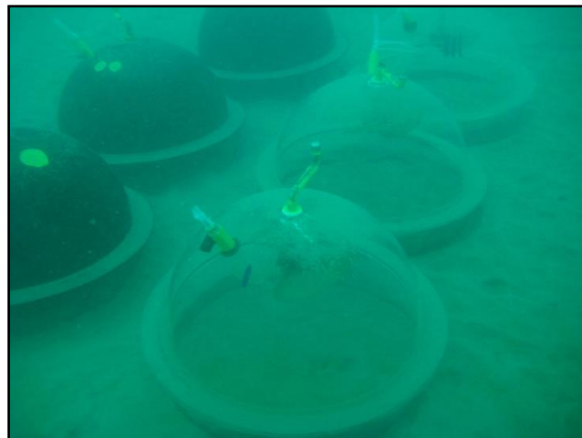
Figura 3. Vista de la colocación de las cámaras bentónicas en el lugar de muestreo.
