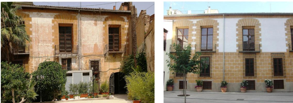
Fotografías de antes y después de la restauración donde se aprecian los sillares fingidos en la fachada del patio trasero.
