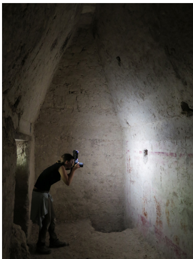
Figura 89. Toma de datos fotogramétrica con la utilización de un foco de iluminación led en La Blanca. Fotografía: Núria Feliu Beltrán, 2017.
