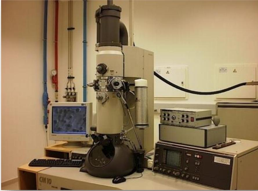
**Figura 12:** Microscopio electrónico de transmisión [29].
