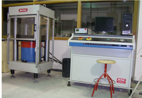
Figura 4.21. Prensa servocontrolada para ensayos de compresión y módulo de deformación.
