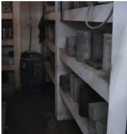
Figura 4.19. Cámara húmeda para curado de probetas.
