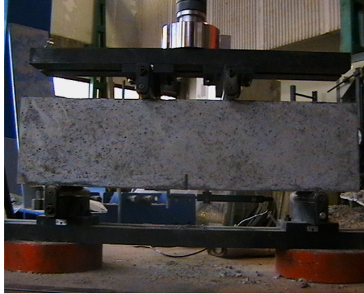
Figura 4.26. Montaje de ensayo a flexotracción empleado en el estudio.
