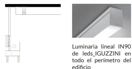
Instalación de iluminación perimetral
