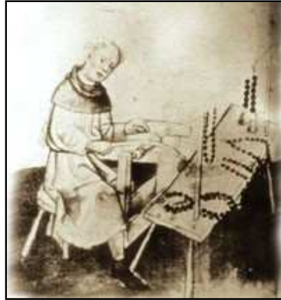
Figura 3.2: Grabado de 1435 de un torno accionado por arco
