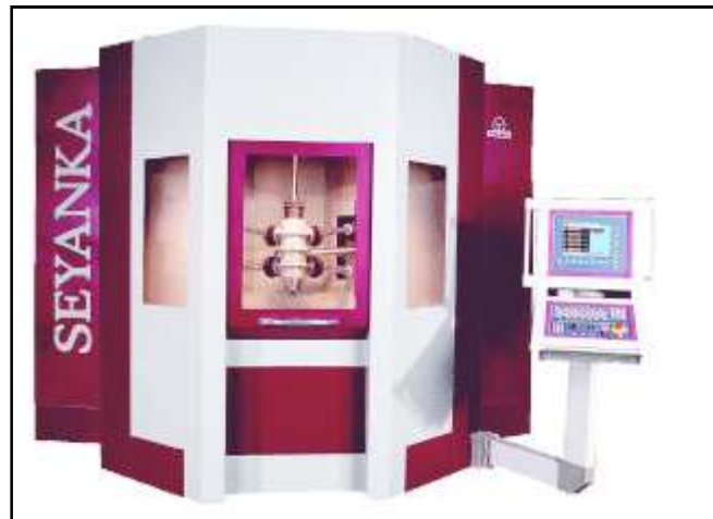
Figura 3.7: Fresadora de estructura cinemática paralela Seyanka
