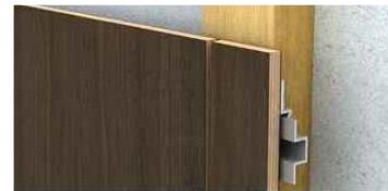
Revestimiento de tabiquería con paneles de contrachapado, con rieles de anclaje a montantes de madera
