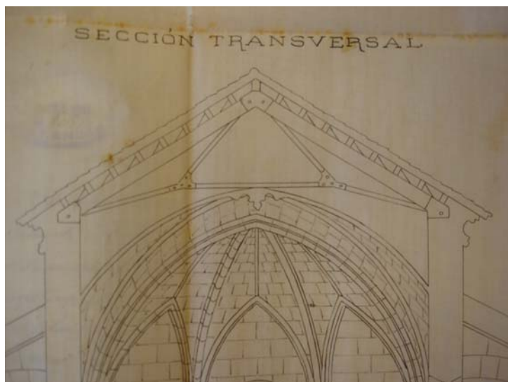
Vista de las cerchas que figuran en el proyecto original de 1903
