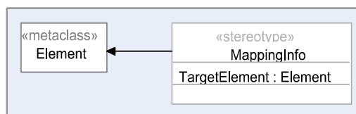
Figura 11. Estereotipo para almacenar la información de mapeo del Metamodelo de Integración
