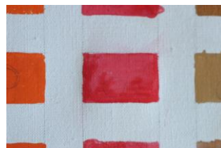
Tras someter a cámara de corrosión por SO 2
