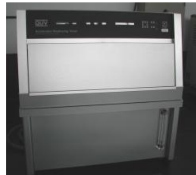
C. de envejecimiento por radiación UV.
