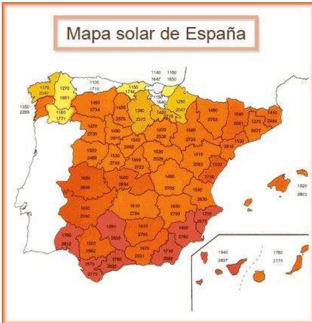
En la imagen se observa el mapa solar de España. En él aparecen, para cada provincia dos cifras, la superior indica los valores de energía, en KWh, que incide por unidad de superficie horizontal, en m<sup>2</sup>, en un año, la inferior representa el número de horas de insolación anuales.
