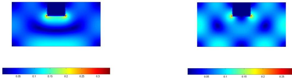
Figura 2.16. Representación del campo eléctrico transversal de los dos primeros modos TM de una guía WR-75 con reentrante centrado de 4 mm de anchura y una altura de 2,976 mm. La frecuencia de corte del primer modo TM ( izquierda ) es de 21,45714 GHz y la del segundo modo ( derecha ) es de 23,38994 GHz.
