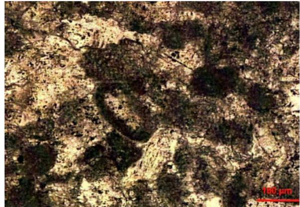
Tesela blanca. Microscopio petrográfico 10x luz transmitida. Detalle microfósil (Borrelli et al. 2007)
