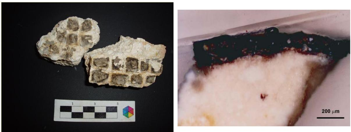
Izquierda: fragmentos de restos de sinopia sobre mortero (derecha). Derecha: Microfotografía (XPL,X200) de la sección transversal de una muestra de la sinopia (Doménech y Osete 2007, 67)
