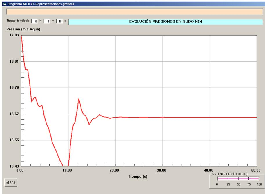
FIGURA 34. EVOLUCIÓN DE LA PRESIÓN EN EL NUDO FINAL DE TRAMO.
