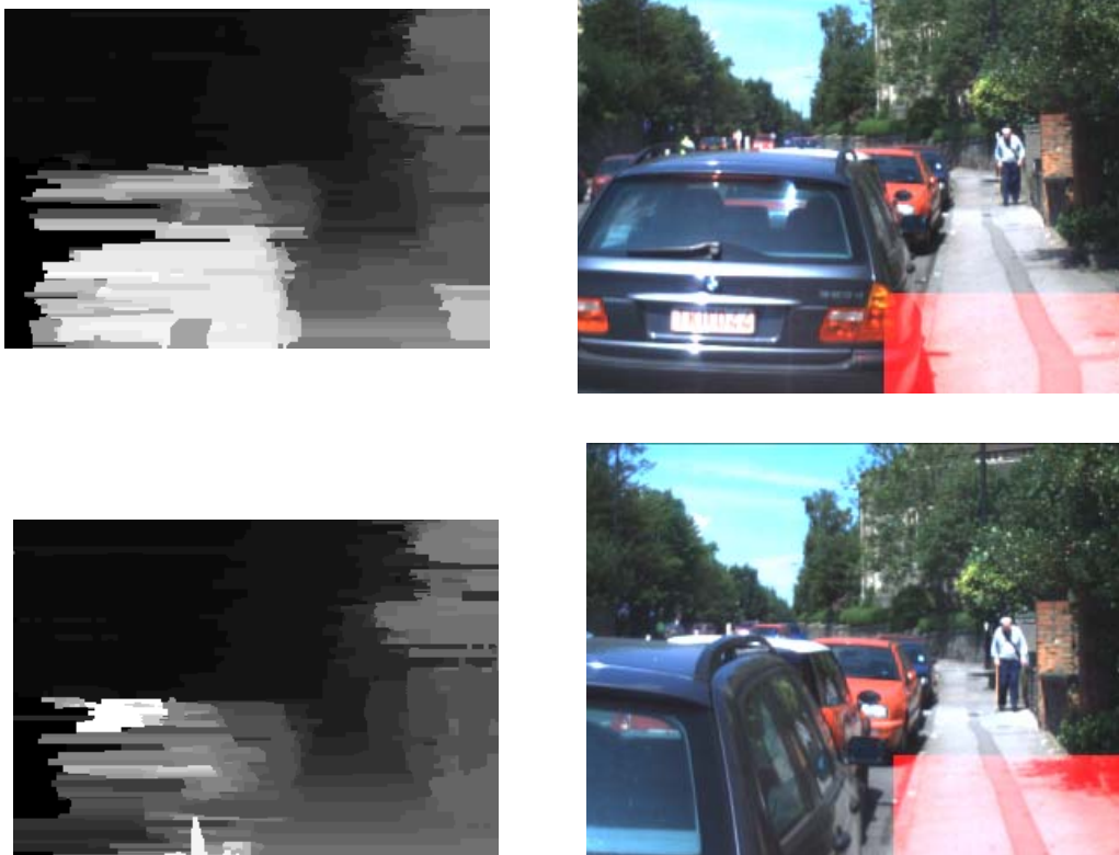
Fig.15. Mapas de profundidad y las respectivas detecciones de camino libre indicadas en color rojo sobre la imagen de la escena real.
