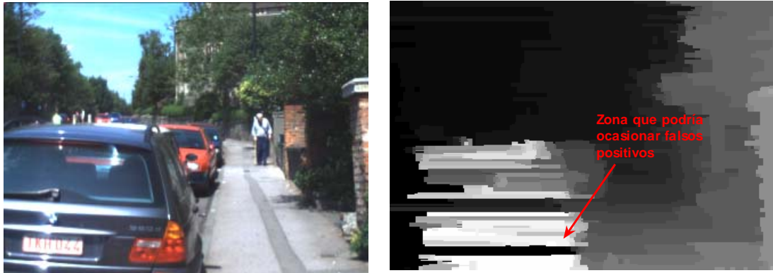
Fig.9. A la derecha se muestra el mapa de profundidad y la zona que podría ser detectada como pasillo, sin serlo, en caso de colocar el umbral de la pendiente de la recta de regresión en 0. A la izquierda se muestra la escena a la que corresponde el mapa de profundidad.
