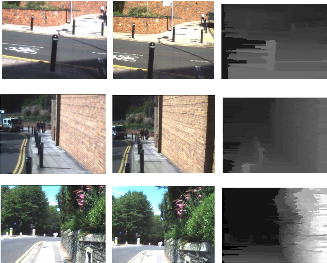
Fig.4. Imágenes de las estereocámaras y sus correspondientes mapas de profundidad.
