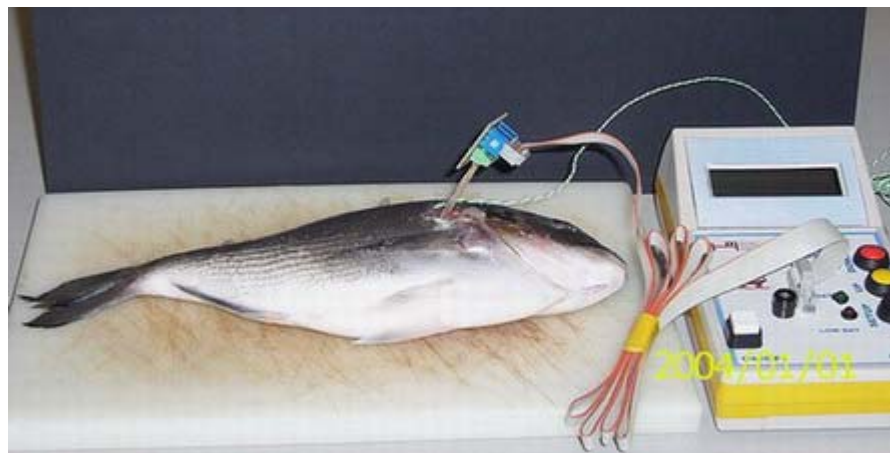
Figura 140. Medidas con pescado con el equipo de medida portátil
