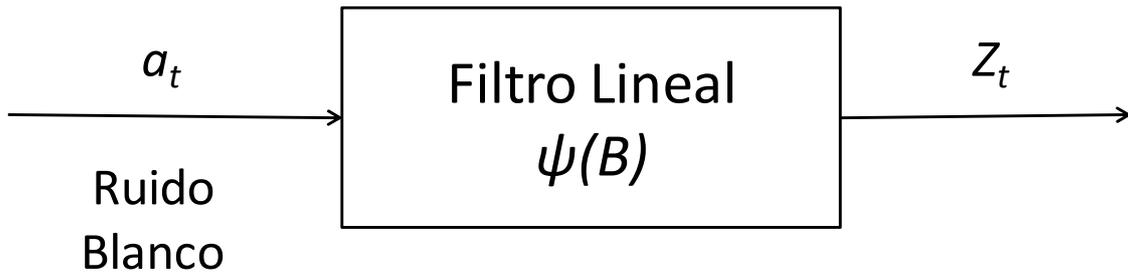
Figura 3.8. El filtro lineal como generador de una serie temporal. Modificado de Box *et al.*, (2008).
