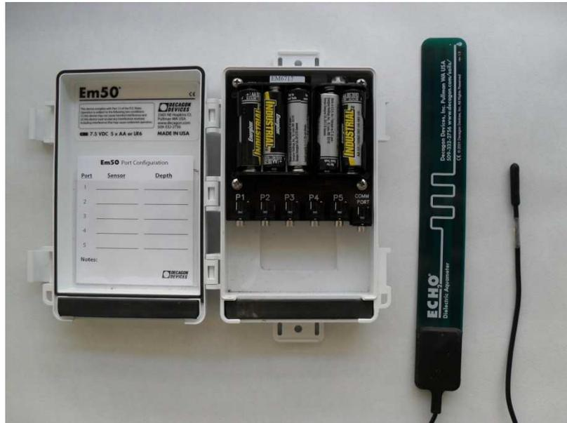
Figura 3.6. Datalogger EM50 (izquierda), sonda de humedad EC-20 (centro) y sonda de temperatura (derecha).
