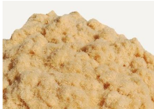
Figura 4.29 Aislante térmico fibra de madera a granel. Imagen GUTEX
