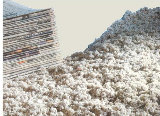
Figura 4.23 Materia prima y resultado del triturado. Imagen de Biohaus
