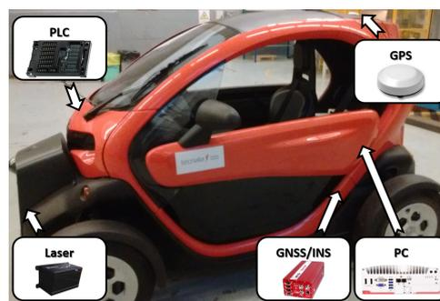
Figura 7: Vehículo Twizy instrumentado
