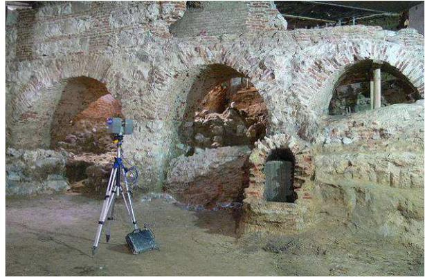
Fig. 5. Proceso de escaneo láser.
