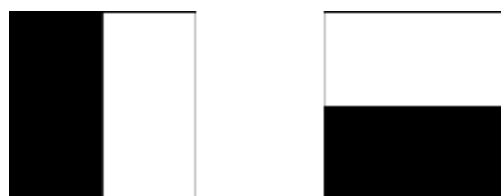
FIGURA 3.17: WAVELET DE HAAR. DERECHA DIRECCION X. IZQUIERDA DIRECCION Y
