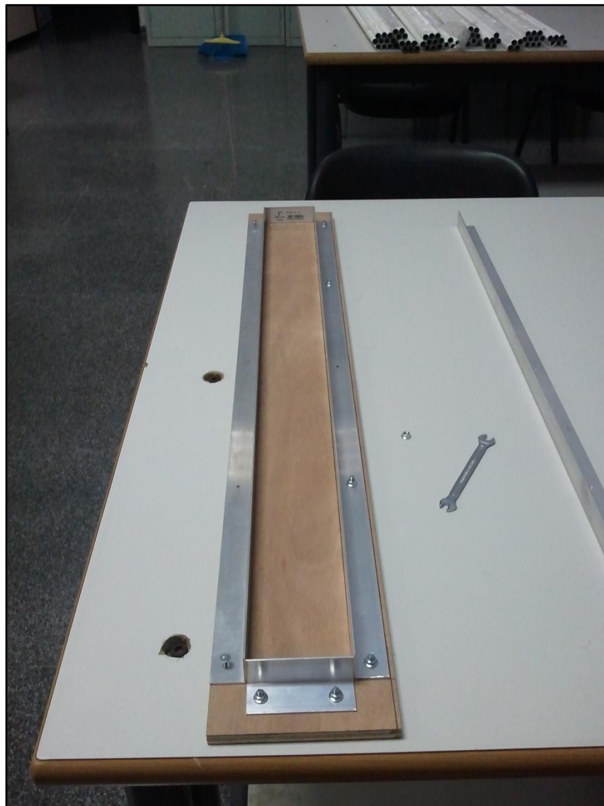
Fig. 19.- Base para el difusor. La parte superior e inferior son iguales.
