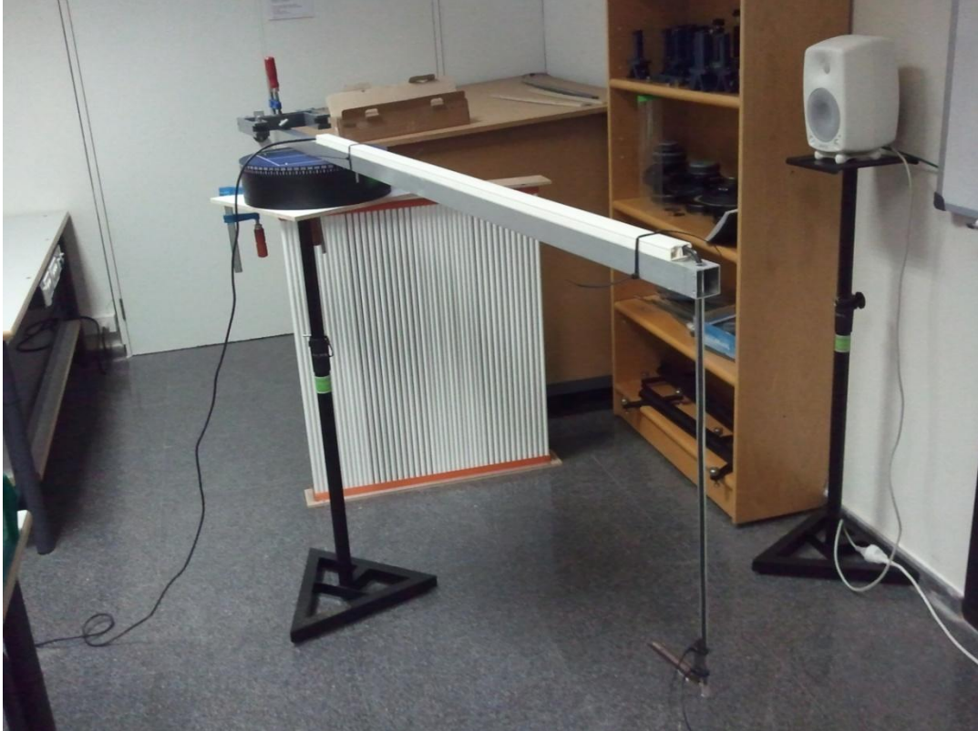
Fig. 28.- Montaje del brazo robotizado que sujeta el micrófono
