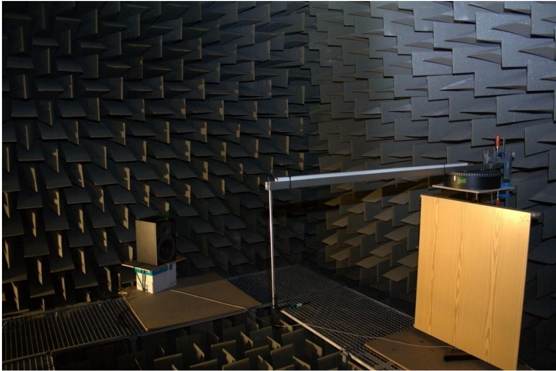
Fig. 34 Medida con superficie totalmente reflectante.
