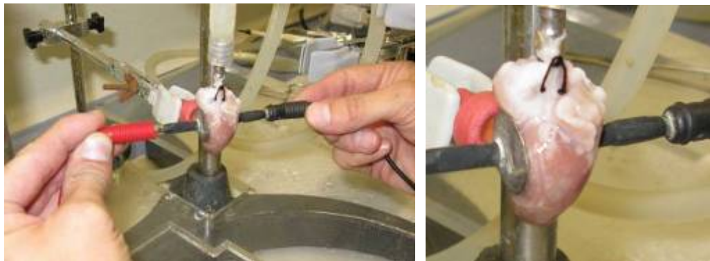
Figura 16. Instant de la desfibril·lació i detall de l'aplicació sobre la preparació
