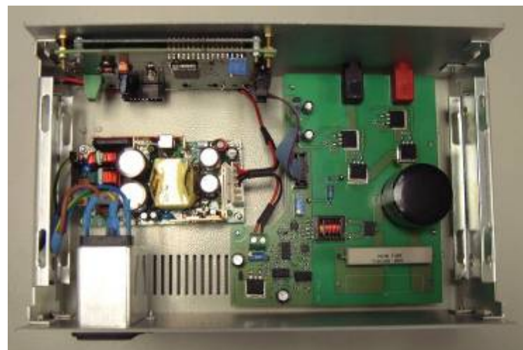
Figura 9. Circuiteria interna del desfibril·lador
