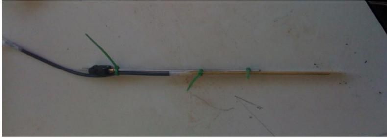
Fig. 3.40 Termopar y sensor óptico para medida de temperatura.
