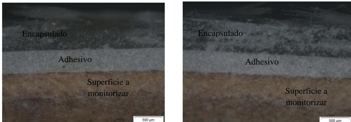
Fig. 3.76 Imágenes del microscopio, donde se observa el espesor del adhesivo con la escala.
