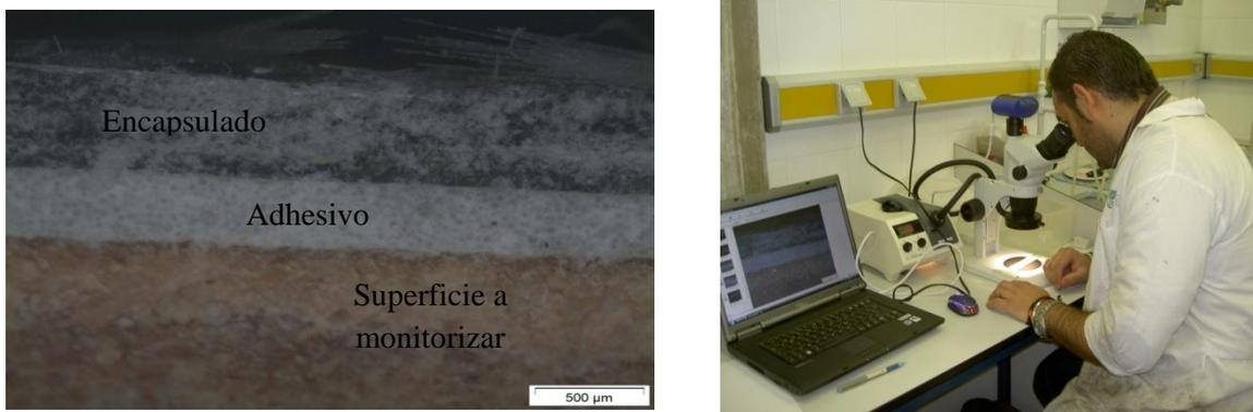
Fig. 3.68 Sección transversal del encapsulado, adhesivo y superficie a monitorizar (a). Trabajo con el microscopio durante una medición (b).
