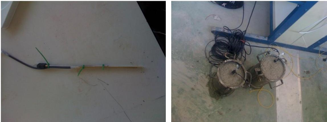
Fig. 3.57 Termopar y sensor óptico que serán embebidos en el hormigón (a). Probetas de hormigón instrumentadas (b).
