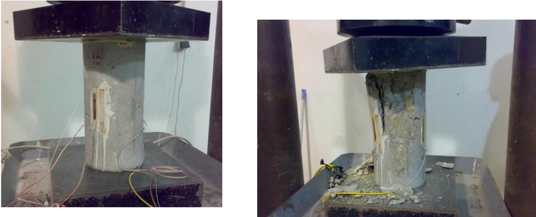
Fig 3.31 Probeta de hormigón monitorizada, antes (a) y después (b) de la rotura.
