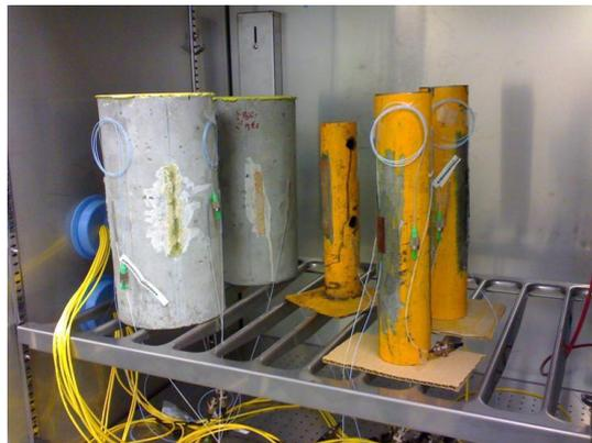
Fig. 3.21 Probetas metálicas y de hormigón empleadas en las campañas experimentales.
