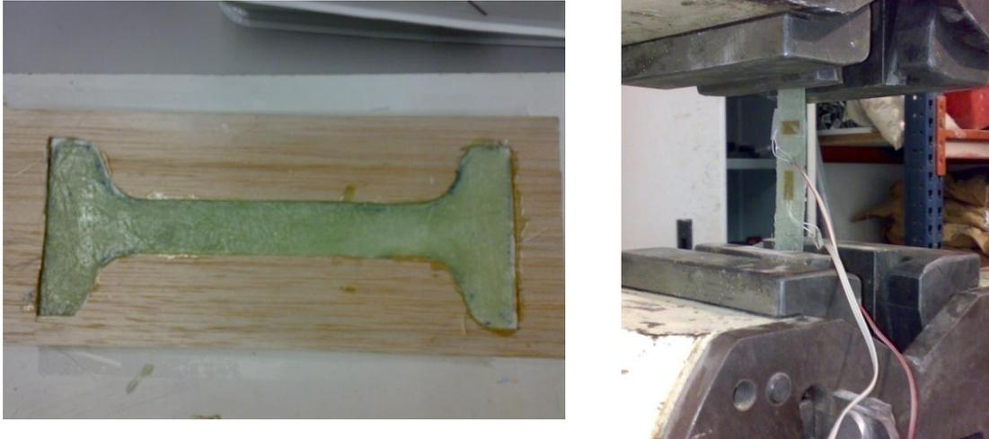
Fig. 3.67. Imagen de las probetas durante la fabricación (a). Instante del ensayo (b).
