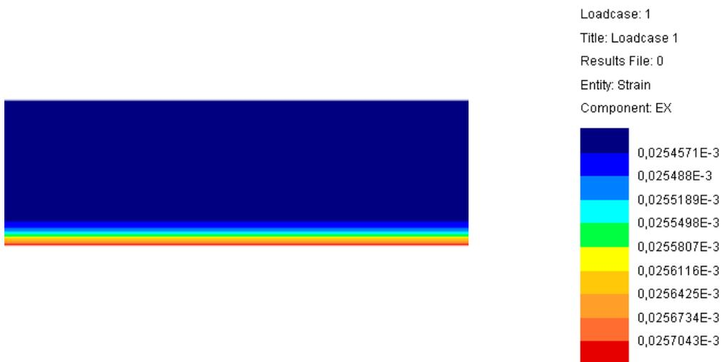
Fig. 3.90 Gradiente de deformaciones que se produce en la base inferior del sensor óptico. Sección transversal del encapsulado.
