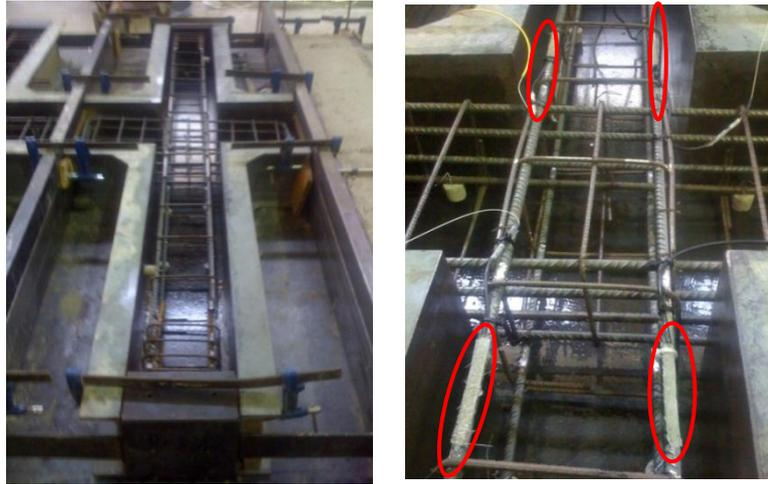
Fig. 3.61 Imagen del armado del nudo viga-soporte (a). Galgas y sensores ópticos adheridos sobre la armadura, señalados en rojo (b).
