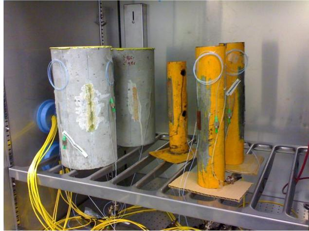
Fig. 3.42 Probetas metálicas y de hormigón en el interior de la cámara climática.
