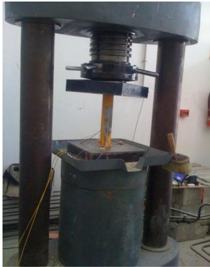
Fig 3.34 Probeta metálica colocada en la prensa.
