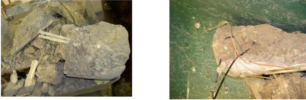
Fig. 3.50 Sensor óptico embebido en el hormigón una vez llevado a cabo el ensayo (a). Imagen del cableado empleado para una mejor protección (b).
