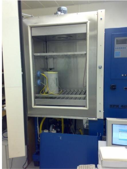
Fig. 3.23 Cámara climática empleada para la realización de los ensayos. Laboratorio del ITEAM.
