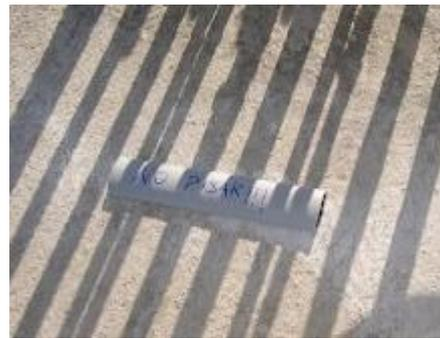
Fig. 3.109 Protecciones adoptadas para el sensor óptico.
