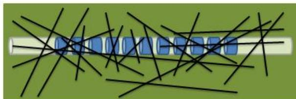
Fig. 3.65 Aleatoriedad en los pelos de la fibra de vidrio y afección sobre la red de Bragg.
