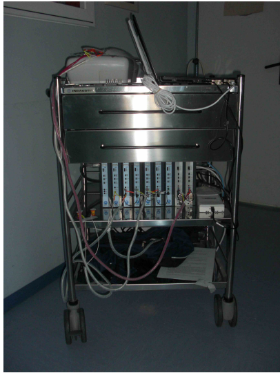
Figura 4.16: Carro hospitalario con el sistema montado (izq): Monitor Corometrics 170 Series (bandeja superior izquierda), ordenador Compac 610 (bandeja superior derecha), amplificadores Biopac(primeras baldas centro), tarjeta de adquisición NI- 6211 de National Instruments(primeras baldas izquierda). Amplificadores Biopac(derecha)
