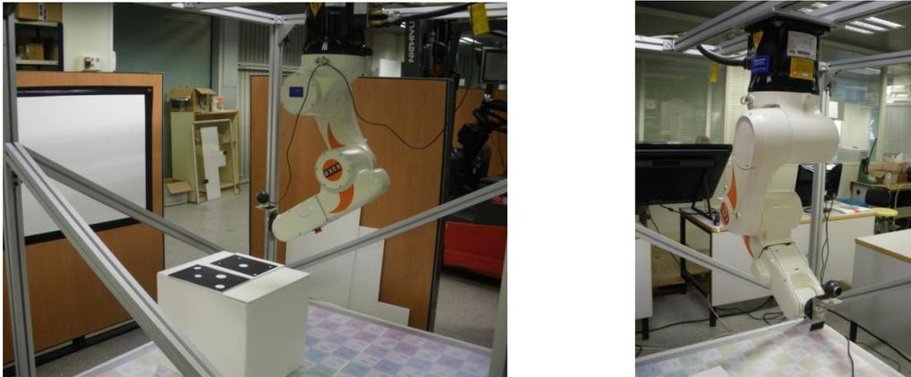
Figura 100. Estructura de sujeción del Kuka KR5 sixx R650.
