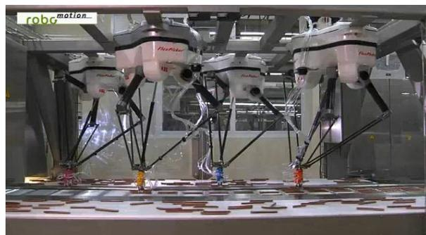
Figura 4. Aplicaciones industriales del Visual Servoing, ABB Flex-Pick de salchichas.
