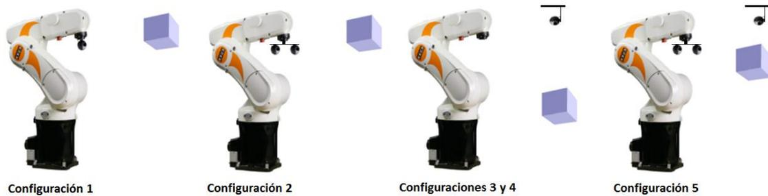
Figura 8. Configuraciones Cámara-Robot utilizadas en el *Visual Servoing* (de izquierda a derecha): Configuración 1 *monocular eye-in-hand*, Configuración 2 *stereo eye-in-hand*, Configuraciones 3 y 4 *monocular* y *estéreo stand-alone* y Configuración 5 sistema de cámaras redundantes.
