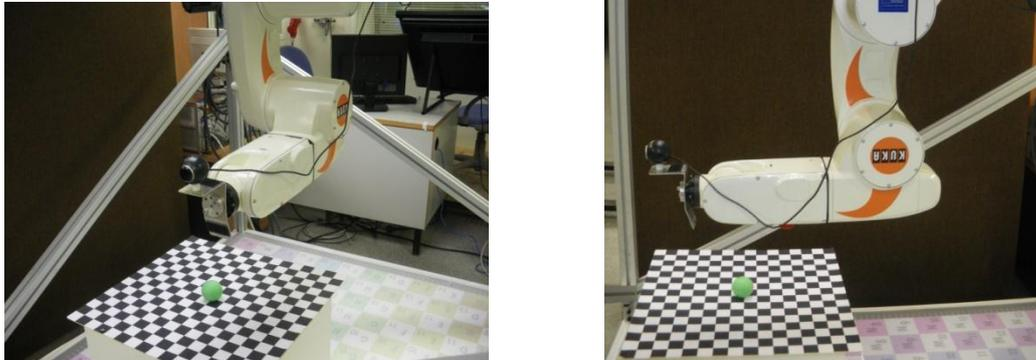
Figura 80. Robot Kuka KR5 sixx R650 para aplicación de Visual Sevoing.
