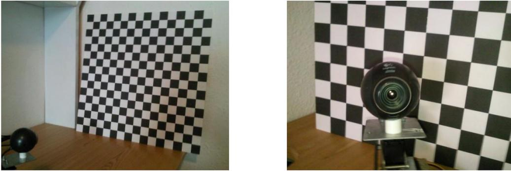
Figura 46. Montaje de calibración. Webcam Logitech C300 y plantilla de calibración.
