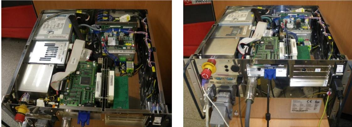
Figura 84. Unidad de control KC 2 del Kuka KR5 sixx R650.
