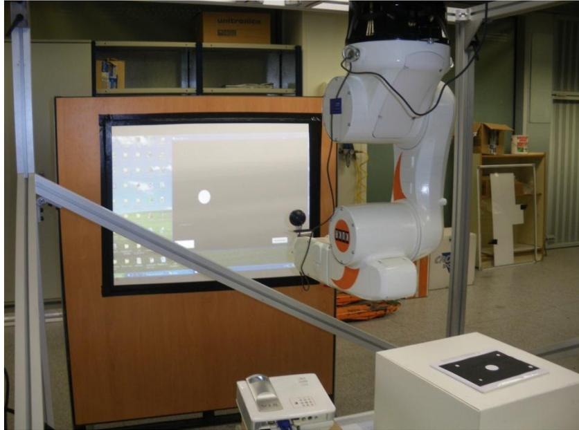
Figura 82. Sistema Visual Servoing para experimentación: la mayor parte de los experimentos se realizarán utilizando un proyector para poder tener una referencia real del objeto y poder luego estudiar los resultados obtenidos.
