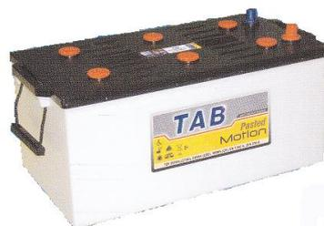
Este tipo de baterías es similar a las de arranque (automoción) pero modificadas. Tanto el electrodo positivo como el negativo son placas de rejilla. Como el material activo se puede colocar sobre la rejilla de forma sencilla los costes de fabricación suelen ser menores que los de otros tipos.
