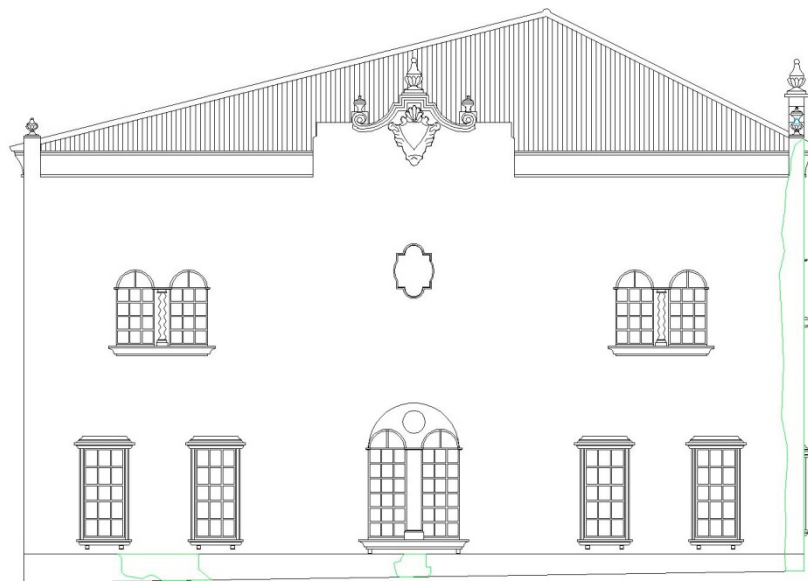
Figura 2.11 – Alzado de la fachada Norte donde se muestra su cuadro patológico.
