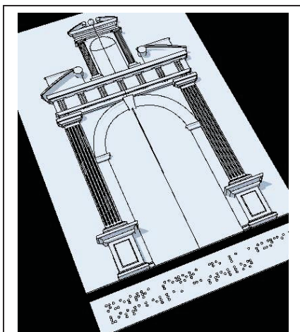
Fig. 8: Modelado en 3D, su geometría ha sido simplificada para mejorar sus prestaciones táctiles. Fuente: J. Gual
