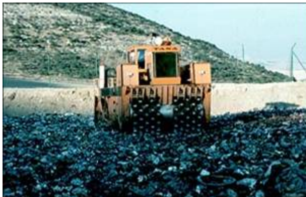
Imagen 2.5. Vertedero de alta densidad con trituración [12]
