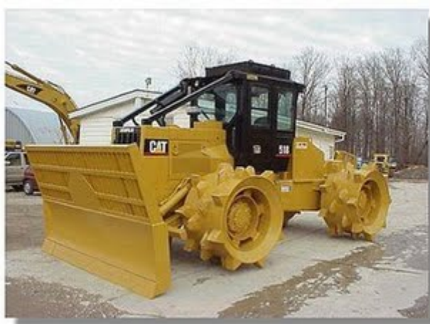
Imagen 2.2. Maquinaria para trituración in situ [12]
