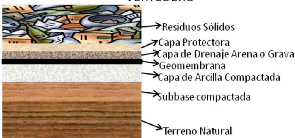
Figura 4.2 Reconocimiento de capas y materiales típicos de un Vertedero
