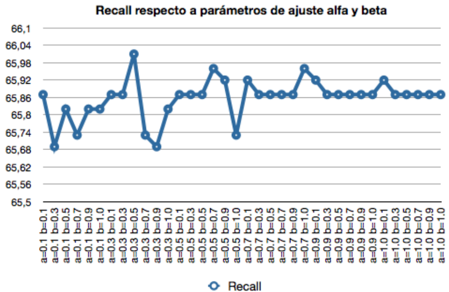
Figura 30: Variación del recall en el combinado de sistemas, de acuerdo a los parámetros de ajuste. La ilustración corresponde a la combinación de los sistemas S_1 - S_3 - S_4 sin factor de promedio ponderado y con solape parcial (corpus tBrown).
